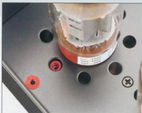
Eine kleine Buchse ist neben jeder Endröhre angeordnet. Das sind die Messpunkte zur Ruhestromeinstellung
